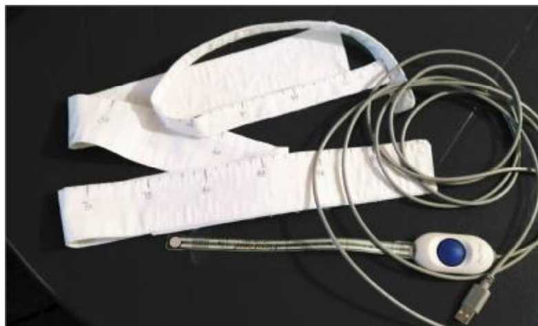
Рис.3.7. Пояс со шкалой для фиксации датчика и задания конструктивных прибавок
