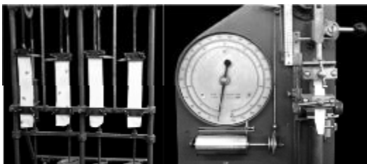
Рис.4.1. Приборы первой группы для измерения одноцикловых неразрывных и разрывных характеристик растяжения (релаксометр-стойка, РТ-250)
